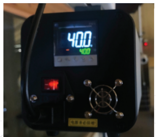
▲ Abbildung 3: Kalibriereinheit mit der emittierten Temperatur (in Celsius)
