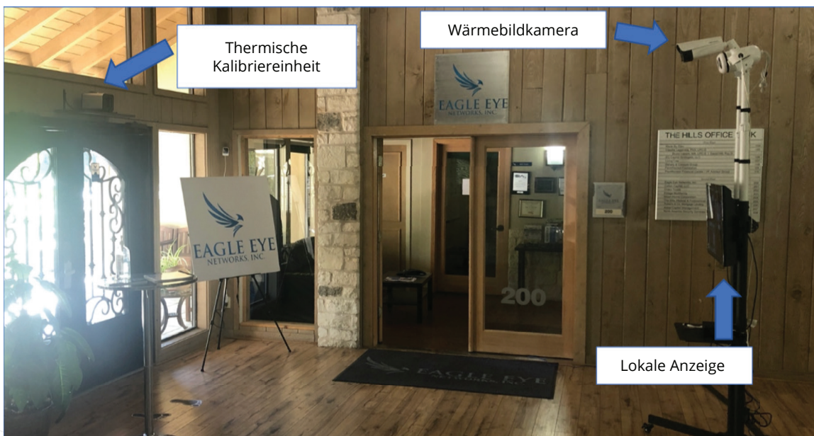
▲ Abbildung 5: Aufstellen der Wärmebildkamera in einem Foyer eines Bürogebäudes
